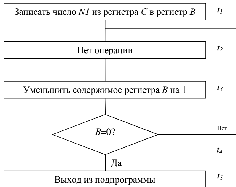
Рисунок 4.1 – Алгоритм работы простой подпрограммы временной задержки
