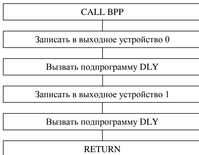
Рисунок 4.2 – Схема алгоритма работы подпрограммы генерации звуковых колебаний
